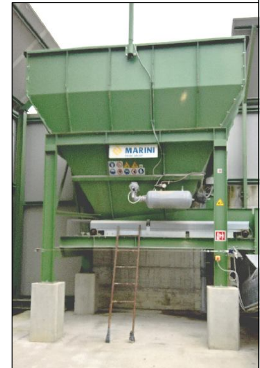
TIPOLOGIA TRAMOGGIA DA IMBULLONARE SUI PILASTRINI ESISTENTI
